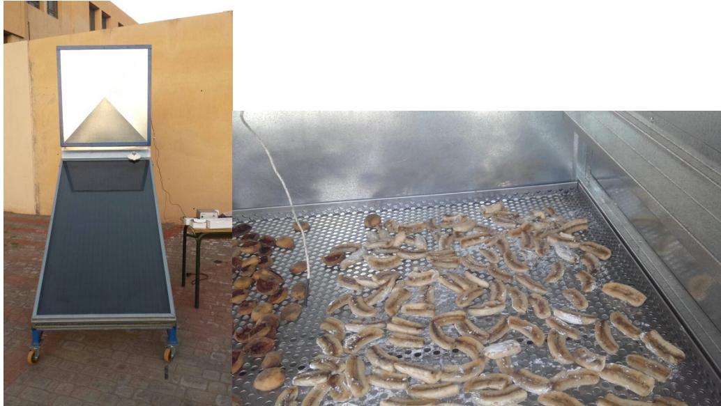
Photo 1- prototype de séchoir développé entre l'IFST de Marrakech et une coopérative membre du cluster Menara
